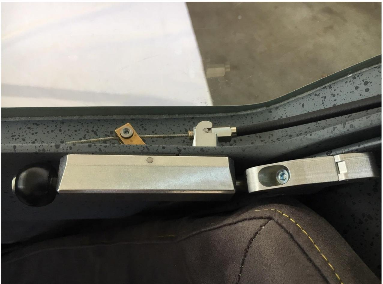
**Beschreibung:** Die zusätzliche Haubenverriegelung verhindert ein Aufbiegen des Haubenrahmens an den beiden Seiten, welches durch starken Sog bei Geschwindigkeiten von über 300km/h vorkommen kann.
